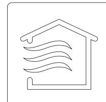
Включите функцию вентиляции и дайте ей поработать до полного высыхания внутреннего блока
