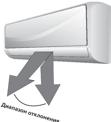
**! Осторожно!** Не задавайте вертикальный угол отклонения жалюзи, близкий к отвесному, на длительное время. Это может вызвать образование капающего конденсата.
