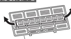
Потяните, чтобы снять с воздушного фильтра
